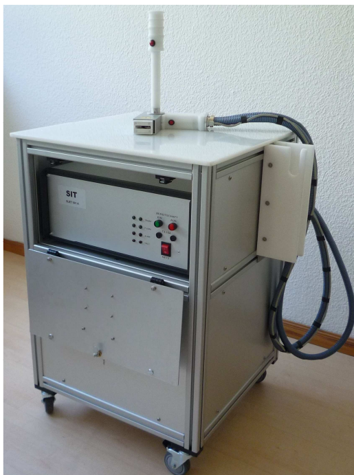
2.: Zwei-Hands-System mit Steuerung und Verriegelung zum sicheren Betrieb Seitliche Halterung zur Aufnahme der Elektrode bei Nichtbenutzung
